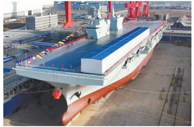
甲板の状況（青い建屋の下が電磁カタパルト）
